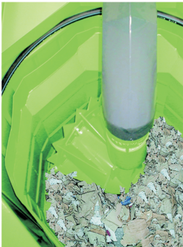
3. Valțul special prinde, rupe și comprimă deșeurile la un nivel de comprimare de până la 9:1
