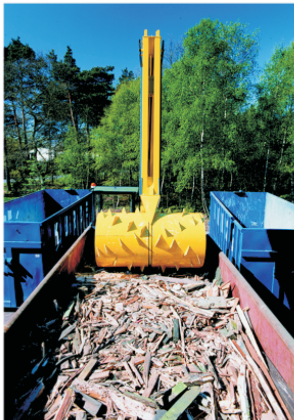
Valțul prinde, rupe și comprimă deșeurile.
